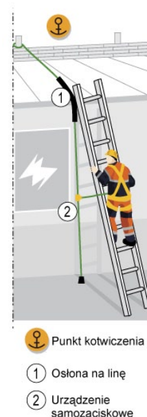
Rys. 3. Bezpieczne wejście na dach
