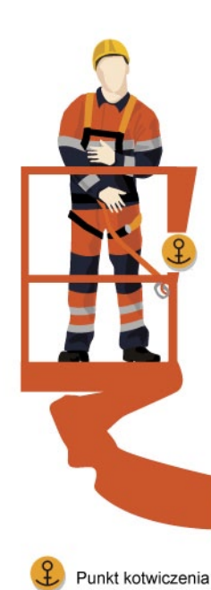
Rys. 4. Punkt kotwiczenia w podnośniku koszowym
