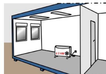
Rys. 4. Ogrzewanie kontenerów ogrzewaczem elektrycznym
