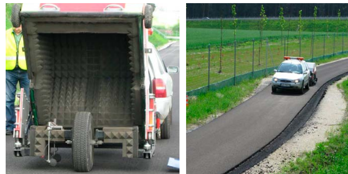
Rysunek 11 Przyczepka pomiarowa CPX oraz badanie na odcinku
