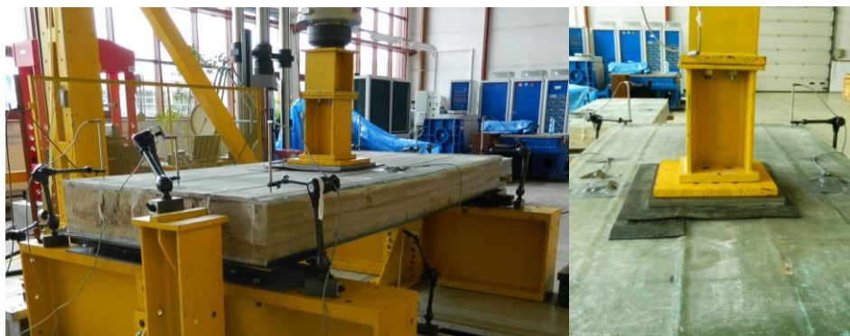
Rys. 5. Panel I podczas badań wytrzymałościowych (po lewej) oraz widok przyłożenia obciążenia skupionego na górnej powierzchni panelu (po prawej)
