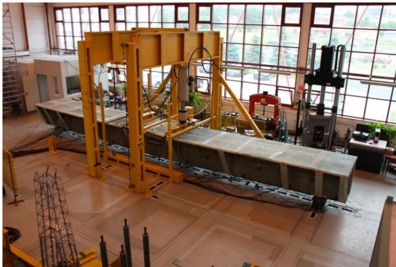
Rys. 7. Badania dźwigara kompozytowego pod obciążeniem statycznym
