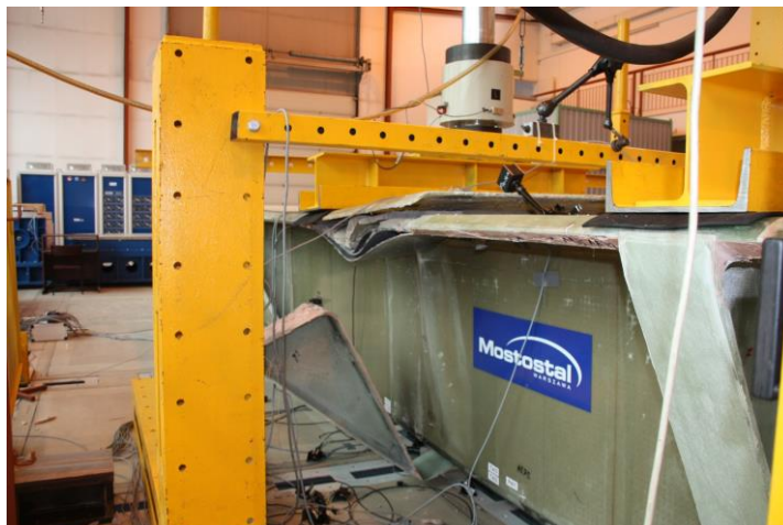
Rys. 9. Postać zniszczenia dźwigara
