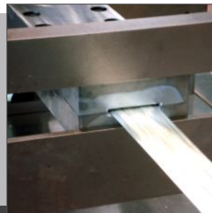
Produkcja taśmy kompozytowej w procesie pultruzji FRP tape pultrusion production process
