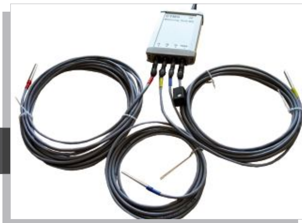
Węzeł pomiarowy z sensorami Measuring node with probes
