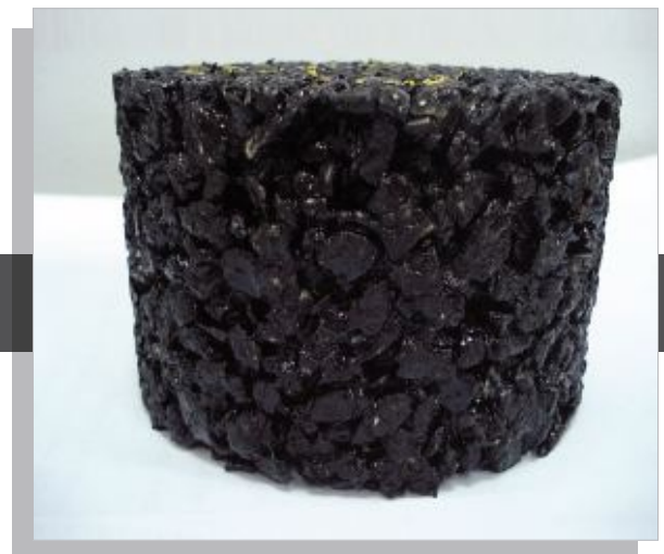
Próbka Marshalla – mieszanka porowata Marshall sample – porous mix
