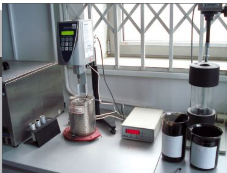
Badanie lepkości asfaltu modyfikowanego nanorurkami Viscosity test of asphalt modified with nanotubes
