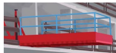
Rys. 1. Pomost roboczy transportowy na wysuwnicach
