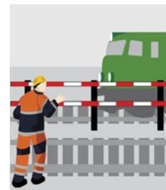
Rys. 3. Oznakowanie międzytorza kolejowego
